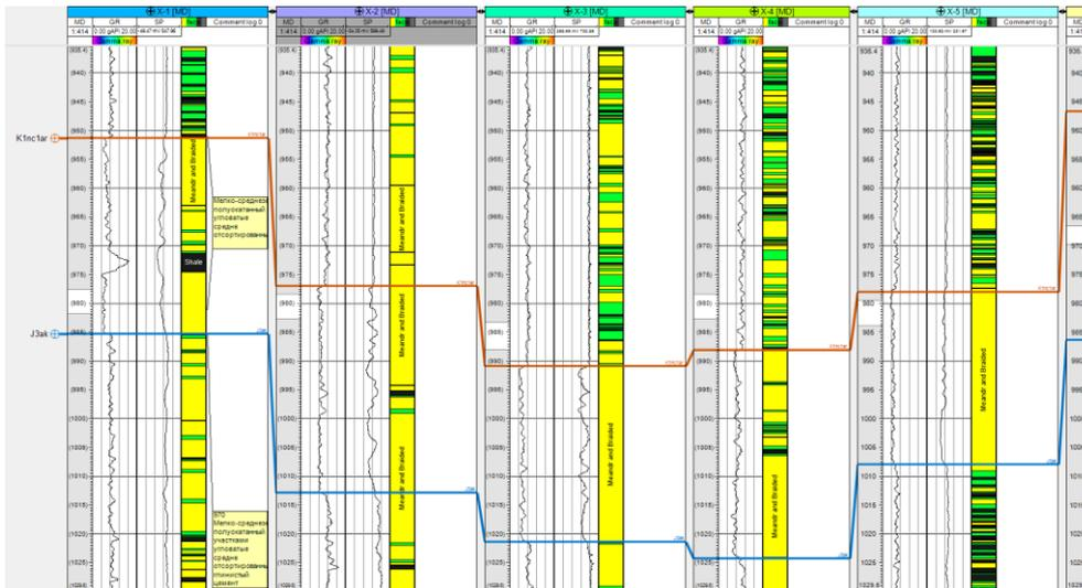
Рисунок 1.4 - Корреляционная схема по скважинам меловой системе арыскомскому ярусу.
